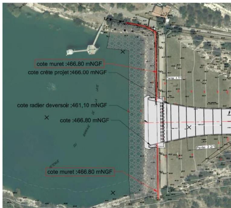
Figure 1 : Schéma d'implantation de l'évacuateur de crues porté sur le talus aval (SCP, 2015)
