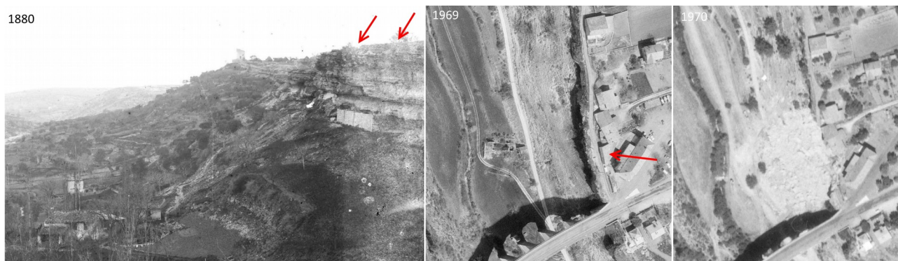
Illustration 1: Photographie aérienne de l'éboulement de 1970 dans la vallée du Viou. Un ancien corps de ferme, visible sur la photo de 1880 et de 1969 est enseveli par l'éboulement rocheux. Une construction (designé en rouge sur la photo de 1969) à l'amont est emporté par le décrochement, estimé à une dizaine de mètre de large. L'analyse par stéréophotographie montre un décrochement net.
